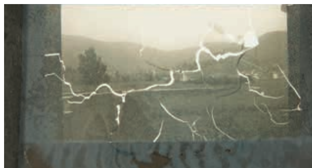
Foto met schade door delaminatie
