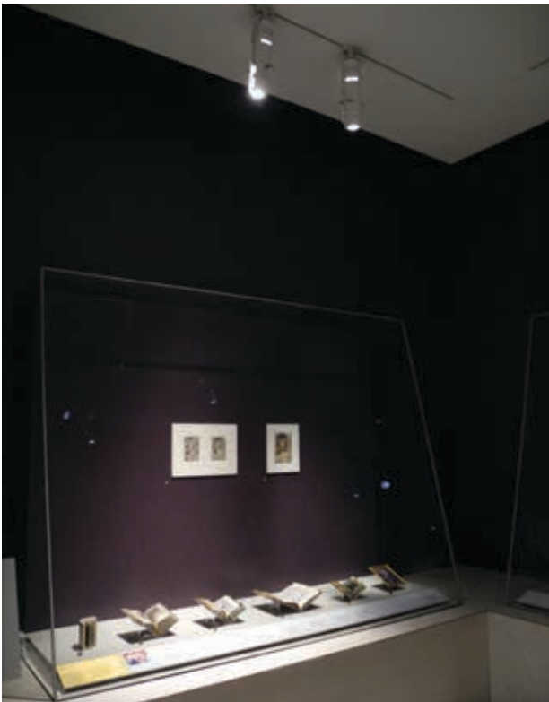
Lichtbron op grote afstand voor lichtgevoelige boeken, buiten de vitrine in V&A Museum, Londen. © FARO
